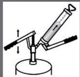
Remplissage par distributeur de graisse vrac
